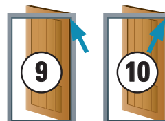
9 Montaggio su architrave Persiana a Destra Uscita cavo a Destra
