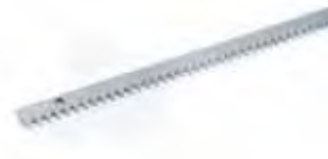
Cremagliera zincata 30x8 mod. 4 con attacchi con fissaggio meccanico inclusi (confez. da 4 m)
